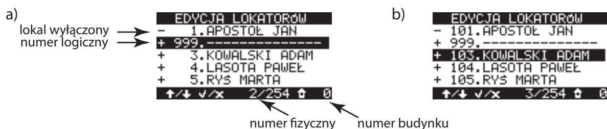
Rys. 9.4 Lista lokatorów. Numery fizyczne i logiczne. Tryb normalny (a), tryb z przesunięciem zakresu (b). Do numeru fizycznego 2 przypisany na stałe numer 999. Lokal nr 1 jest wyłączony.
