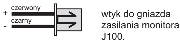
Rys 8. Wtyk gniazda zasilającego monitor
