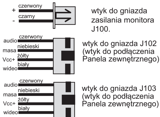
Rys 7. Złącza w monitorze MVC-7002
