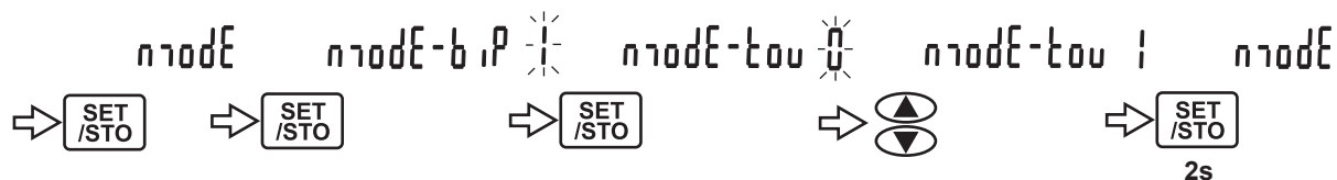
Rys.6.3 Obsługa menu na przykładzie menu „mode” i zmiany wartości parametru tov.
