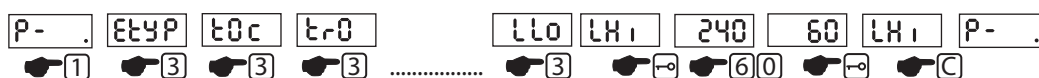
Rys. 8.3 Przykład korzystania z procedury P-1. Parametr LHi (górny zakres obsługiwanych numerów) zostaje ustawiony na wartość 60.
